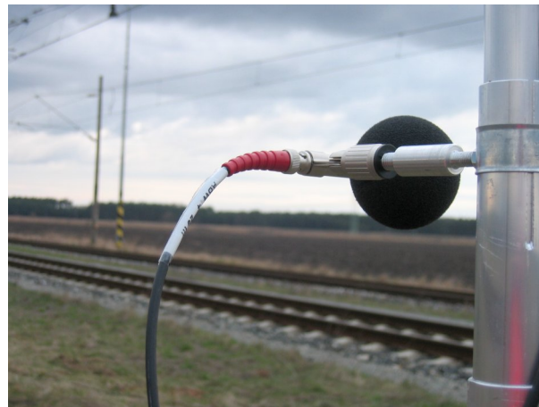
Mikrofon bei der Messung eines Fahrzeuges
